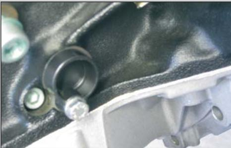
7. Quite el tapón del cárter del cigüeñal y enrosque el fijador del cigüeñal (Nº. 3242)
