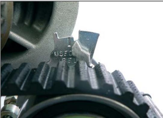
Apriete el tornillo del rodillo tensor con 20 Nm.
