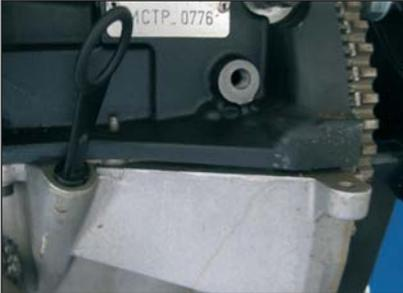
4. Gire el cigüeñal hacia la derecha hasta la posición de ajuste.
