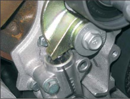
Sujete la varilla de presión con un perno fijador de 2 mm de diámetro que se mete en la caja del tensor por el agujero
