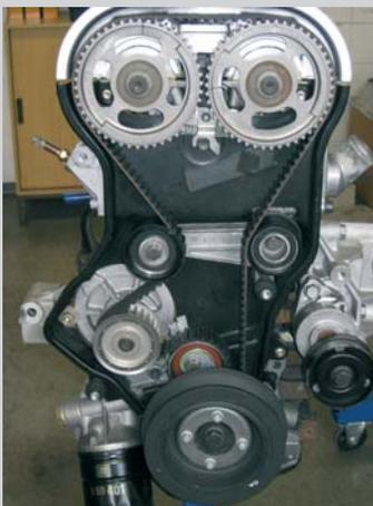
El motor 1,8i 16V C 18 XE va montado en grandes cantidades, con diferentes variantes de cilindrada, en modelos de la marca Opel. Al cambiar la correa de distribución, se hacen a menudo importantes fallos al ajustar el rodillo tensor.
