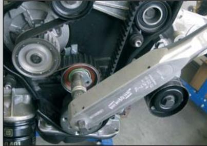
14. Gire de nuevo la transmisión del motor dos veces, controle el ajuste y ajuste de nuevo en caso necesario.
